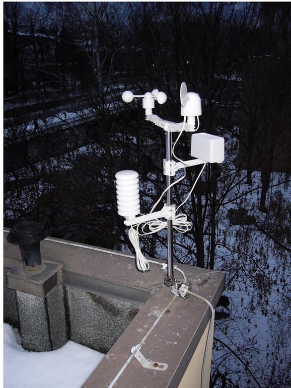
Abbildung 3.7: Die Wetterstation am Standort erfasst im Abstand von fünf Minuten die klimatischen Bedingungen
