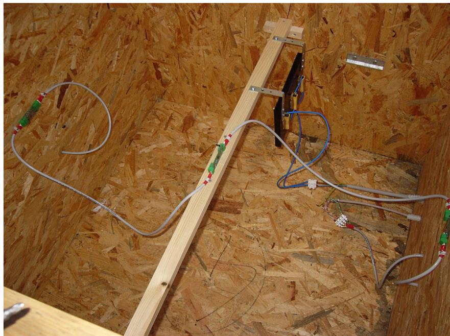
Abbildung 3.5: Innenausstattung der Cubes: Messsonden für Oberflächentemperaturen süd- und nordseitig, Sonde für Raumtemperatur und relative Luftfeuchtigkeit und Heizmodul
