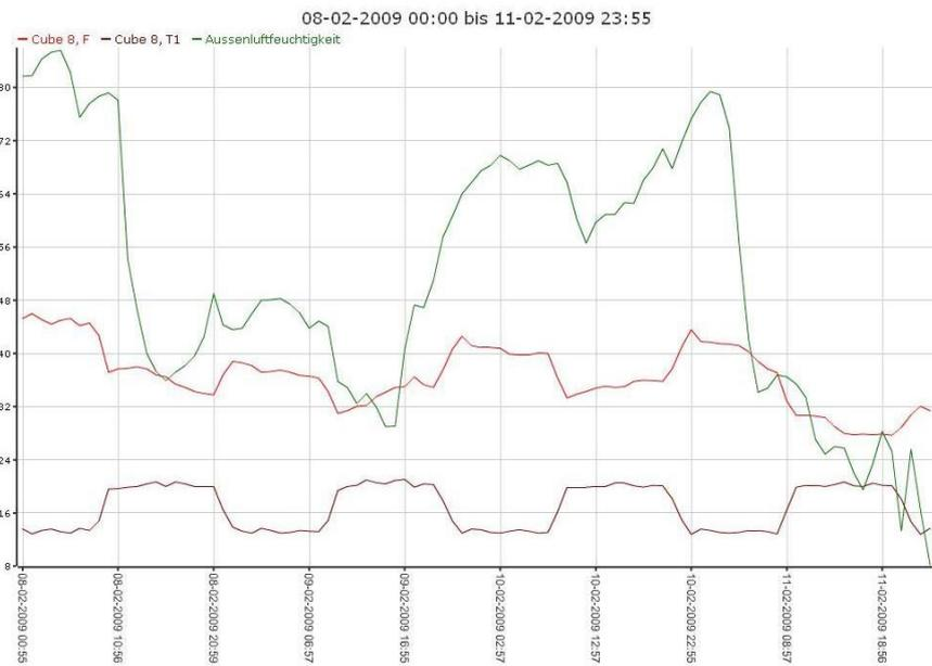
Abbildung 5.15: Änderung der relativen Luftfeuchtigkeit bei Änderung der Temperatur: steigt bei gleichbleibender Beladung die Temperatur (braune Linie), dann sinkt die relative Luftfeuchtigkeit (rot) und umgekehrt. Eine wesentliche Änderung der Außenfeuchtigkeit (grün) hatte keinen Einfluss auf den Verlauf im Cubeinneren (Cube 8, Stundenmittelwerte vom 8. bis 11. Februar 2009 [10])
